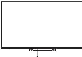
Pritisnite ovaj gumb u stanju pripravnosti za uključivanje/isključivanje TV-a.
