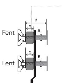
Nagy fali tátartót (nem tartozék a TV-hez) a négy fali rögzítőcavarral kell használni, hogy a TV fali rögzítő konzolok a hátsó burkolat fölre kerüljenek.
