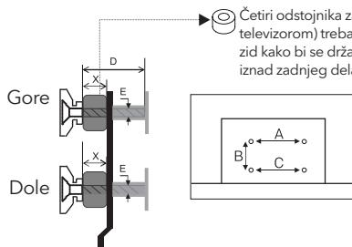
Četiri odstojnika za montažu na zid (nisu isporučeni sa televizorom) treba koristiti sa četiri vijka za montažu na zid kako bi se držači za montažu televizora na zid podigli iznad zadnjeg dela kućista.
