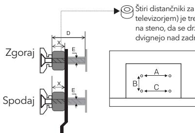
► Štiri distančniki za montažo na steno (niso priloženi s televizorjem) je treba uporabiti s štirimi vijaki za montažo na steno, da se držala za montažo televizorja na steno dvignejo nad zadnjim delom ohaja.
