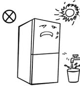
Conservez l'appareil à l'abri de la chaleur et de la lumière directe du soleil. Ne le placez pas dans un endroit humide ou à proximité d'un point d'eau pour éviter la formation de rouille ou la diminution de l'effet isolant.
