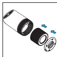
6. Okrenite poklopac u smjeru kazaljke na satu iz **otvorenog** u položaj **LOCK**. Čut ćete zvuk "klik", što znači da je poklopac pričvršćen. (f)
