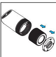
4. Remove the packaging material of the new filter. (d)
