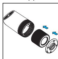
6. Okrenite poklopac u smjeru kazaljke na satu iz položaja **OTVORENO** u položaj **LOCK**. Čućete zvuk "klik", što znači da je poklopac pričvršćen. (f)
