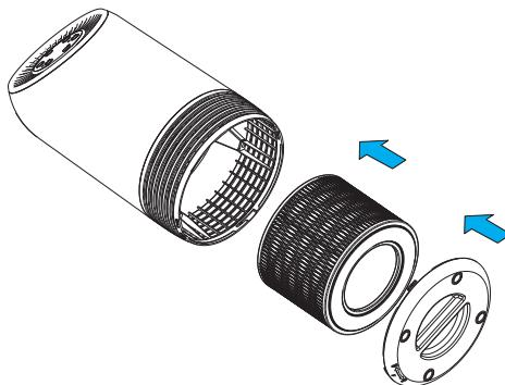
5. Okrenite poklopac baze u smjeru kazaljke na satu iz **OPEN** u **LOCK položaj**. Kada čujete zvuk "klik", poklopac je pričvršćen.
