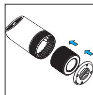
6. Fordítsa az alsó fedelel az óramutató járásával megegyező irányba az **OPEN** állásból a **LOCK** állásba, ekkor egy kattanást fog hallani, ezzel a fedél rögzült. (f)
