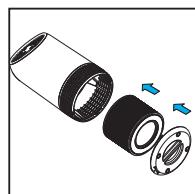
6. Răsuciți capacul inferior în sensul acelor de ceasornic din poziția **OPEN** în poziția **LOCK**, veți auzi un sunet, iar capacul va fi blocat. (f)
