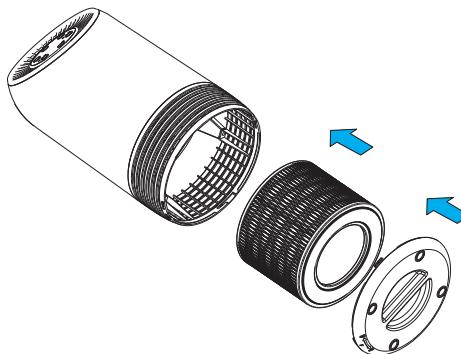
5. Răsuciți capacul inferior în sensul acelor de ceasornic din poziția **OPEN** în poziția **LOCK**, veți auzi un sunet, iar capacul va fi blocat în poziție.
