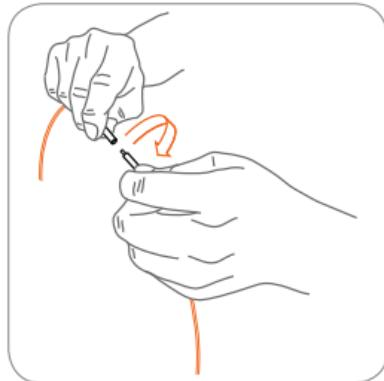
Dok je pritisnut, okrenite konektor na desnoj strani u smjeru suprotnom od kazaljke na satu da biste ga uklonili.
