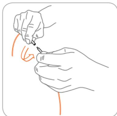
Presione hasta que ambos conectores se unan y gírelo en el sentido de las agujas del reloj para fijarlo.
