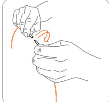
Medtem ko je pritisnjeno, zavrtite konektor na desni v nasprotni smeri urinega kazalca, da ga odstranite.
