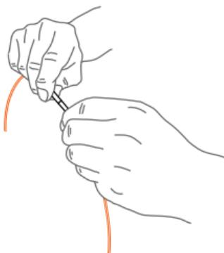
Presione hasta que ambos conectores se toquen
