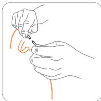
Pritisnite dok se oba konektora ne spoje i okrenite ga u smjeru kazaljke na satu kako biste ga pričvrstili.
