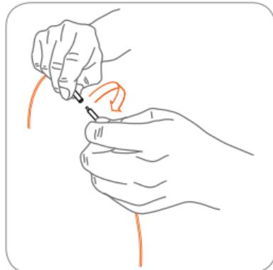
Während er gedrückt ist, drehen Sie den Stecker nach rechts gegen den Uhrzeigersinn, um ihn zu entfernen.
