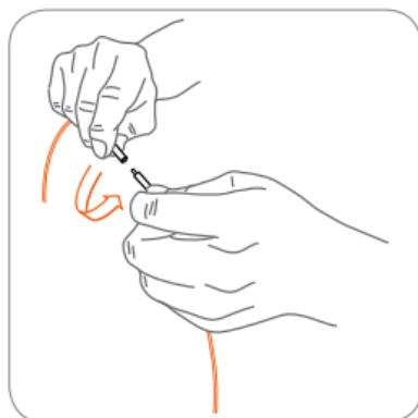
Drücken Sie, bis beide Anschlüsse zusammentreffen, und drehen Sie sie im Uhrzeigersinn, um sie zu befestigen.
