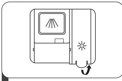
1 Свалете капака на дозатора за препарат за изплакване, като повдигнете дръжката.
