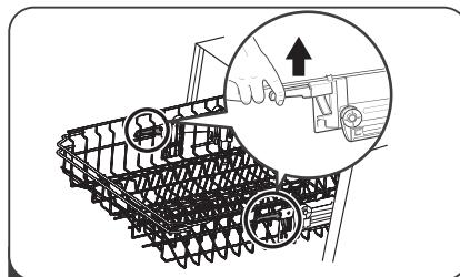
**2** Da spustite policu, pritisnite dršku ka dole i otpustite.
