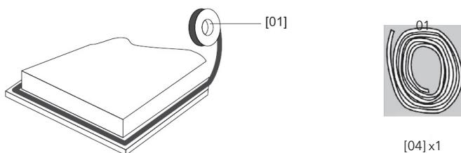
Ispružite isporučenu traku duž donje ivice ploče za kuhanje, vodeći računa da se krajevi preklapaju.
