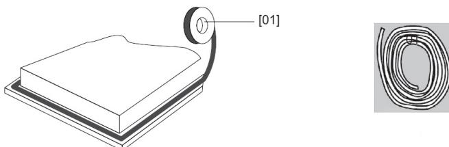
Tegye fel a mellékelt tömítést a főzőlap alsó széle mentén, ügyelve arra, hogy a végek átfedjék egymást.
