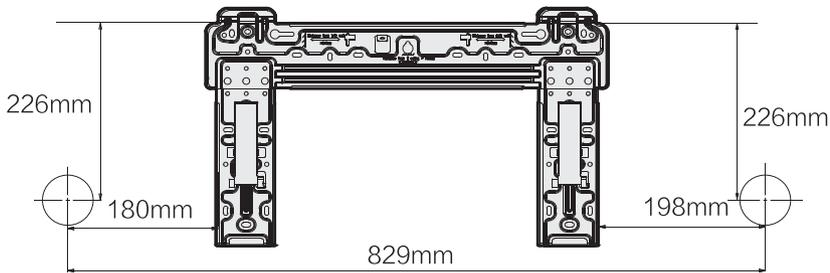
Za način rada 1 i način rada 2, odredite lokaciju bazne rupe u zidu prema sljedećoj dimenziji.
