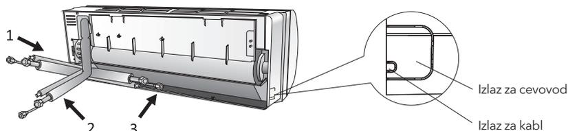
2. Savijanje spojnih cijevi tako da je otvor okrenut nagore, kako je prikazano na slici
