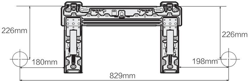
Pentru Modul 1 și Modul 2, stabiliți poziția orificiilor din perete pe baza următoarelor dimensiuni.
