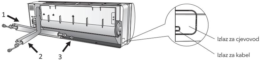
2. Savijte spojne cijevi tako da otvor bude okrenut prema gore, kao što je prikazano na slici
