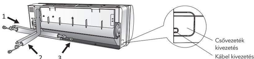
1. Hajlítsa meg a csatlakozó csöveket a nyílással felfelé az ábrán látható módon.
