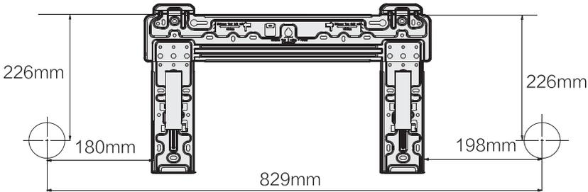
За режим 1 и режим 2, определете местоположението на основата на отвора в стената по следния размер.
