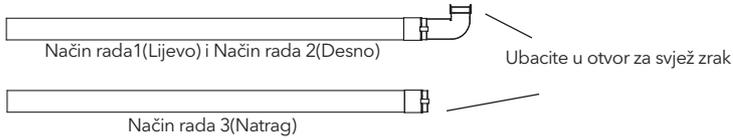
6. Otvorite unutarnju ploču i izvadite držač filtera, postavite HEPA filter za svjež zrak, a zatim vratite držač na mjesto.
