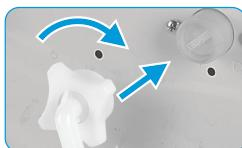
Spojite crijevo za dovod vode na ulazni ventil za vodu i slavinu za hladnu vodu, kao što je prikazano na slici.
