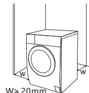
Prije instaliranja stroja, morate pronaći mjesto sa sljedećim karakteristikama:
