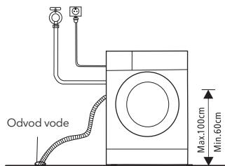
2. Spojite ga na dodatnu odvodnu cijev odvoda vode.
