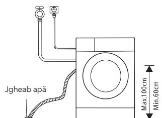
2. Conectați-l la conducta de evacuare a ramificației jgheabului.
