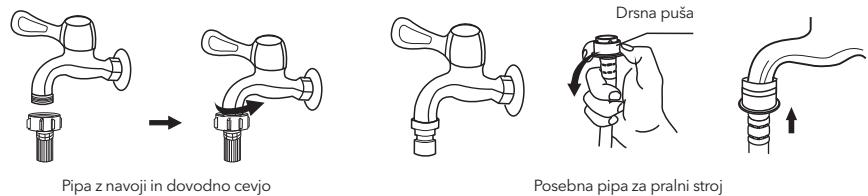
Drugi konec dovodne pipe priklopite na dovodni ventil na zadnji strani stroja in pipo čvrsto privijte v smeri urnega kazalca.
