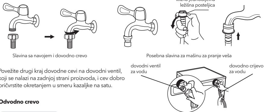
Povežite drugi kraj dovodne cevi na dovodni ventil, koji se nalazi na zadnjoj strani proizvoda, i cev dobro pričvrstite okretanjem u smjeru kazaljke na satu.
