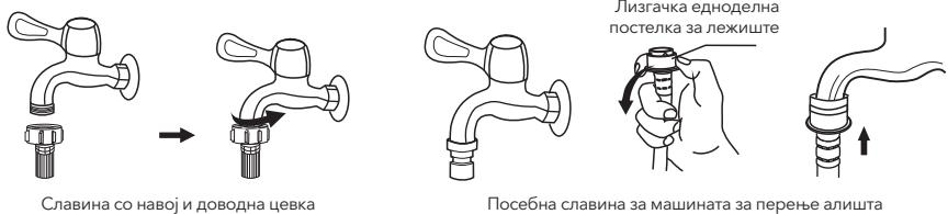
Поврзете го другиот крај на доводната цевка за доводниот вентил, сместен на задната страна од производот, и цевката добро прицврстете ја со движење во насока на стрелките на часовникот.
