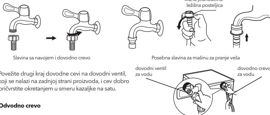
Povežite drugi kraj dovodne cevi na dovodni ventil, koji se nalazi na zadnjoj strani proizvoda, i cev dobro pričvrstite okretanjem u smeru kazaljke na satu.
