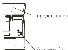
Аварийният бутон е разположен върху капака на електрическия блок за управление на тялото под предния панел.
