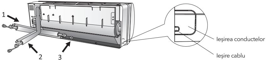
2. Îndoiti conductele de conectare cu orificiul orientat în sus, așa cum se arată în figură.
