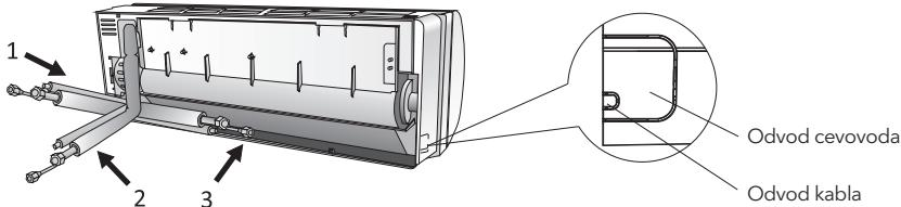
2. Zvijanje priključnih cevi z odprtino, obrnjeno navzgor, kot je prikazano na sliki.
