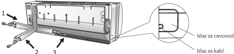
2. Savijanje spojnih cevi tako da je otvor okrenut nagore, kako je prikazano na slici
