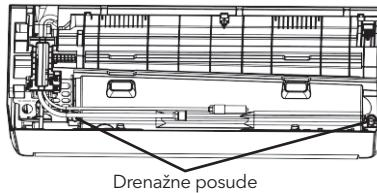
2. Priključite drenažno crijevo na drenažni otvor, provjerite da li je spoj čvrst i da li je brtveni efekat dobar.
