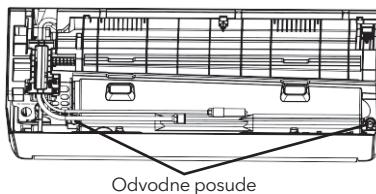
2. Spojite odvodno crijevo na odvodnu rupu, provjerite je li spoj čvrsto stegnut i je li brtveni učinak dobar.
