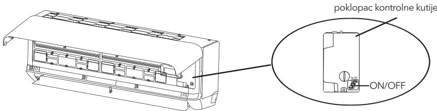
(otvorite ploču unutrašnje jedinice)
