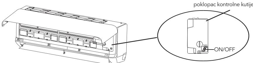
(otvorite ploču unutrašnje jedinice)
