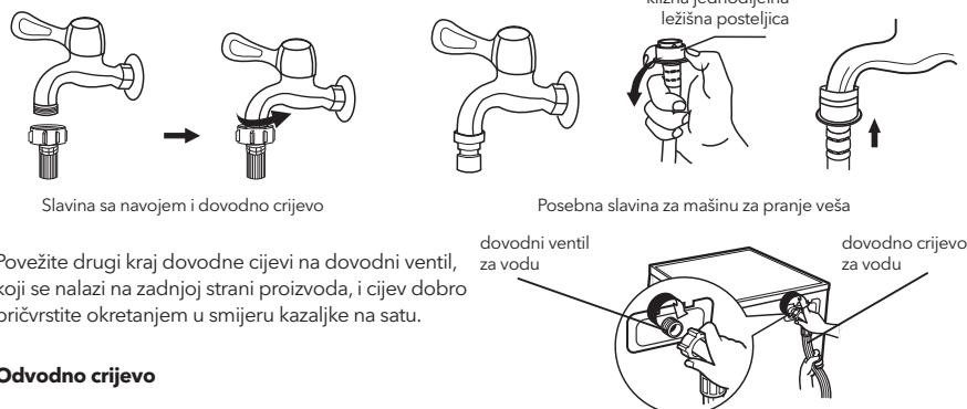
Povežite drugi kraj dovodne cijevi na dovodni ventil, koji se nalazi na zadnjoj strani proizvoda, i cijev dobro pričvrstite okretanjem u smjeru kazaljke na satu.
