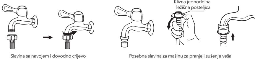
Povežite drugi kraj dovodne cijevi na dovodni ventil, koji se nalazi na zadnjoj strani proizvoda, i cijev dobro pričvrstite okretanjem u smjeru kazaljke na satu.
