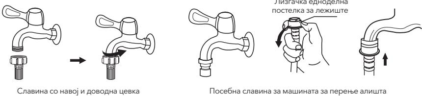
Поврзете го другиот крај на доводната цевка за доводниот вентил, сместен на задната страна од производот, и цевката добро прицврстете ја со движение во насока на стрелките на часовниковит.
