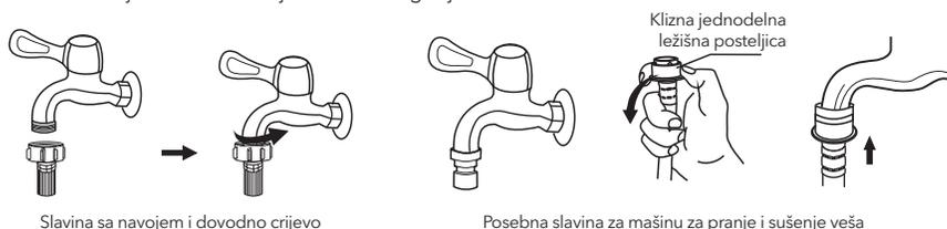
Povežite drugi kraj dovodne cijevi na dovodni ventil, koji se nalazi na zadnjoj strani proizvoda, i cijev dobro pričvrstite okretanjem u smeru kazaljke na satu.
