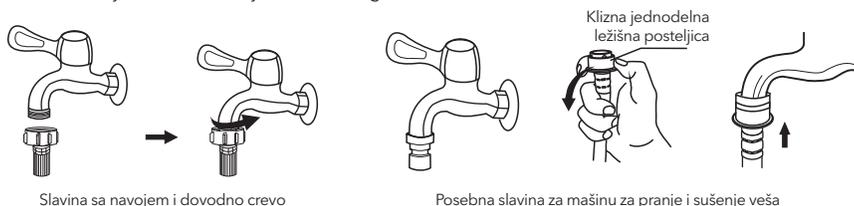
Povežite drugi kraj dovodne cevi na dovodni ventil, koji se nalazi na zadnjoj strani proizvoda, i cev dobro pričvrstite okretanjem u smeru kazaljke na satu.
