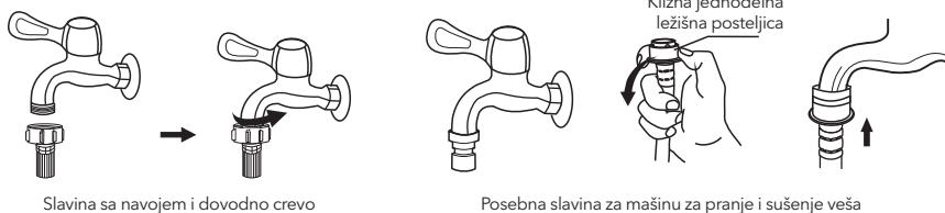
Povežite drugi kraj dovodne cevi na dovodni ventil, koji se nalazi na zadnjoj strani proizvoda, i cev dobro pričvrstite okretanjem u smjeru kazaljke na satu.
