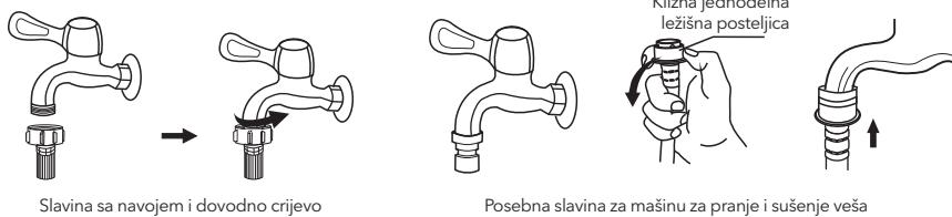
Povežite drugi kraj dovodne cijevi na dovodni ventil, koji se nalazi na zadnjoj strani proizvoda, i cijev dobro pričvrstite okretanjem u smjeru kazaljke na satu.
