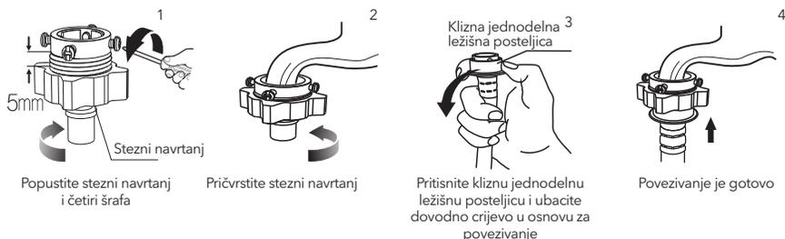
2. Povezivanje slavine sa navojem i dovodnog crijeva.
