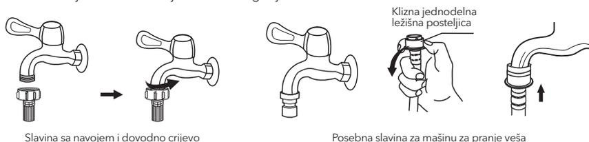
Povežite drugi kraj dovodne cijevi na dovodni ventil, koji se nalazi na zadnjoj strani proizvoda, i cijev dobro pričvrstite okretanjem u smjeru kretanja kazaljke na satu
