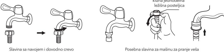
Povežite drugi kraj dovodne cevi na dovodni ventil, koji se nalazi na zadnjoj strani proizvoda, i cev dobro pričvrstite okretanjem u smeru kazaljke na satu.
