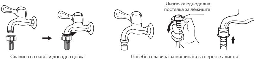
Поврзете го другиот крај на доводната цевка за доводниот вентил, сместен на задната страна од производот, и цевката добро прицврстете ја со движење во насока на стрелките на часовникот.
