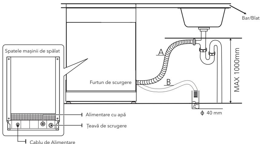
**⚠️** Vă rugăm să fixați sigur furtunul de evacuare în poziția A sau în poziția B
