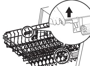
**2** Da spustite polici, pritisnite dršku ka dole i otpustite.
