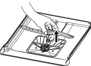
**2** Pentru a scoate elicea inferioară, scoateți elicea în sus.
