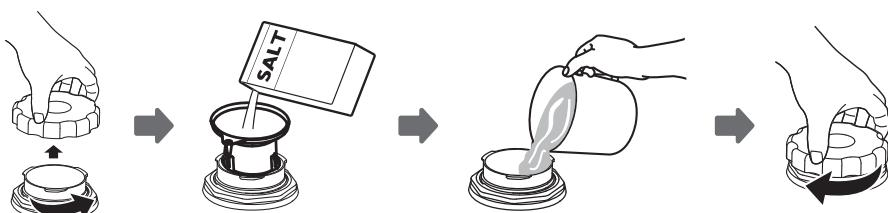
1. Scoateți coșul inferior și deșurubați capacul rezervorului.
