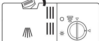
**1** Da otvorite poklopac, pritisnite bravicu za otpuštanje na posudi za deterdžent.
