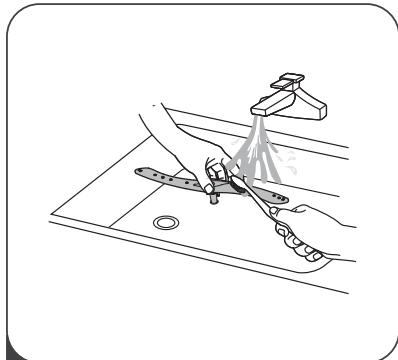
**3** Ručice operite u toploj vodi sa sapunicom, a za čišćenje mlažnica upotrebite meku četku. Nakon temeljnog ispiranja, ponovo ih postavite u uređaj.
