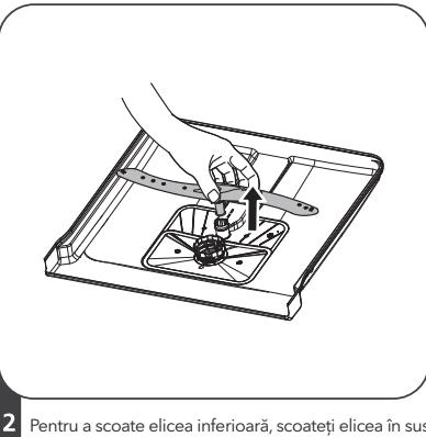
**2** Pentru a scoate elicea inferioară, scoateți elicea în sus.
