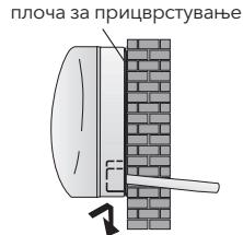
Отако ќе ги поврзете цевките според упатствата, инсталирајте ги и каблите за поврзување. Потоа, инсталирајте ја цевката за празнење. После поврзувањето, покријте ги цевките, каблите и цевката за празнење со изолационен материјал.
